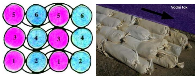
Obrázek 2. Kladení dvoukomorových pytlů [1]
